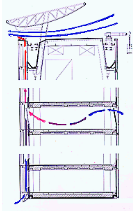
شكل (6) تدفقات الهواء وتحكمها فى فتحات التهوية
